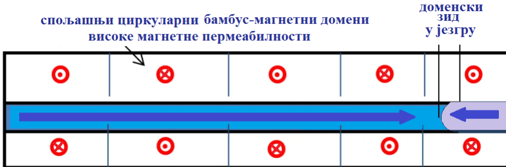
Слика 4-20. Приказ доменске структуре код аморфне жице на бази кобалта: лонгитудинални домени по оси жице (централни и крајњи домен) и циркуларни домени са наизменично супротно оријентисаним векторима магнетизације (структура „бамбус“ домена) уз површину цилиндра.
